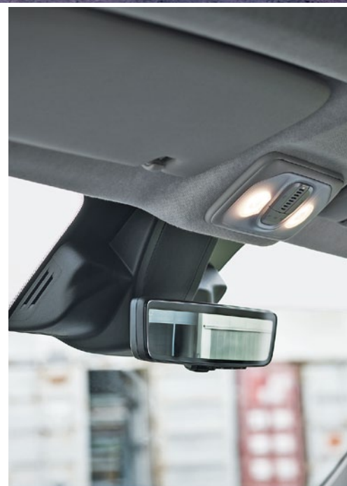
Digitální zpětné zrcátko – pohled dozadu je přenášen kamerou na zrcátko uvnitř vozu.
